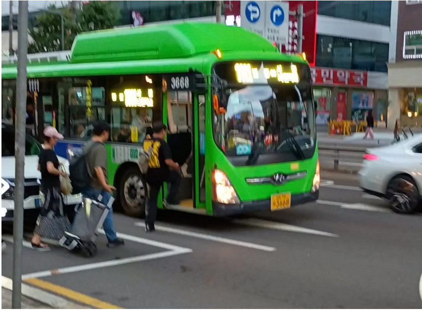
그림 2. 전면 점유 → 차로 정차 → 차도 승차 — 동덕여대앞(44). 정류장 앞쪽 연석에 흰색 승용차가 서 있어 녹색 지선버스가 연석에 붙지 못했다. 앞문이 차도 위에서 열려 승객이 노면에서 곧바로 계단을 오르고, 장바구니 카트를 끄는 승객도 차도를 걷는다. (영상 캡처 VID_20260825_185522622 7 초, 2026-08-25 18:55)
